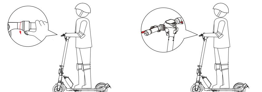
4.加速: もう片方の足をペダルに乗せる。バランスを取った後、右手の電子スロットルを軽く押して加速する。
